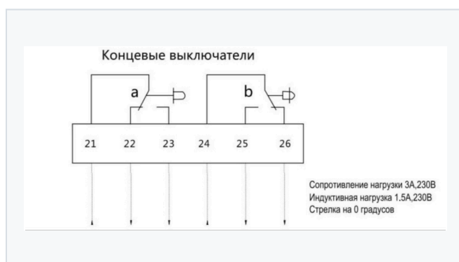
Схема концевых выключателей · SM 230 В
